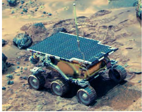
Marsfahrzeug Sojourner, das 1997 bei der spektakulären Mission «Mars-Pathfinder» für direkte Bodenuntersuchungen zum Einsatz kam.
